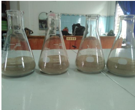
Gambar 10. Serbuk Umbi Gadung yang Sudah ditimbang Sebanyak 75 Gram dimasukkan kedalam Erlenmayer(Sumber: Doc. Pribadi, 2016)
