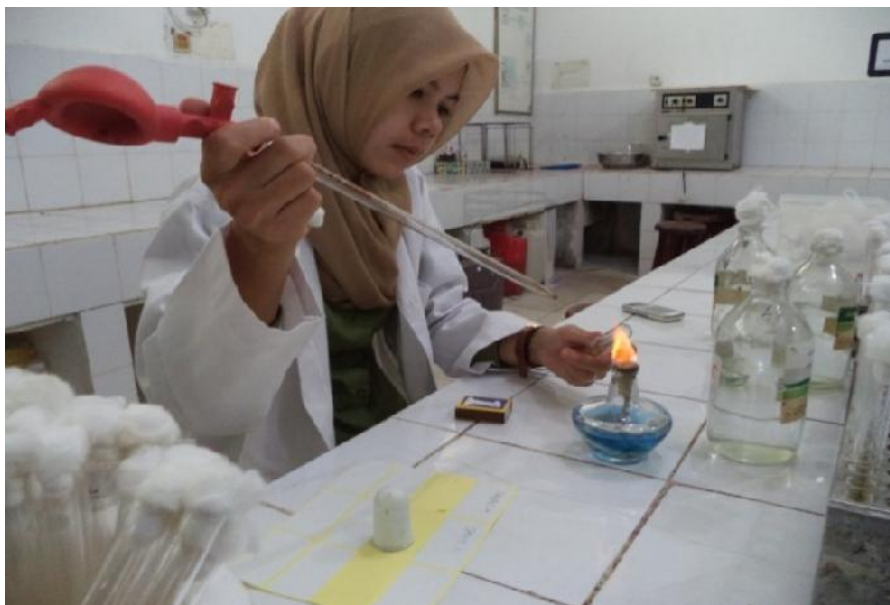
Gambar 9. Proses Mensterilkan Tabung Reaksi (Sumber: Doc Pribadi, 2014)
