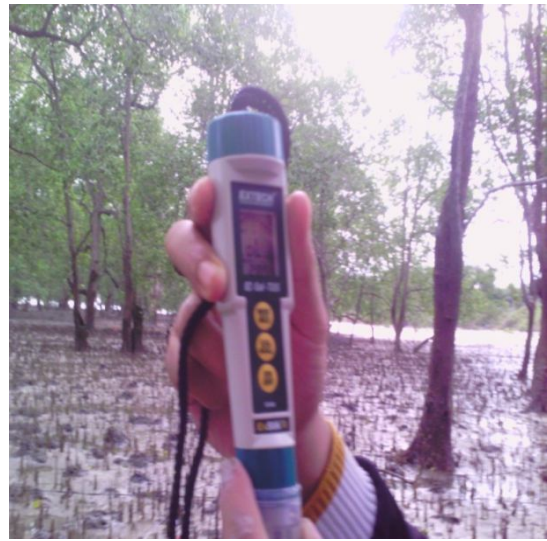
Gambar 39. Pengukuran suhu dan salinitas (Sumber: Dokumen pribadi, 2014)
