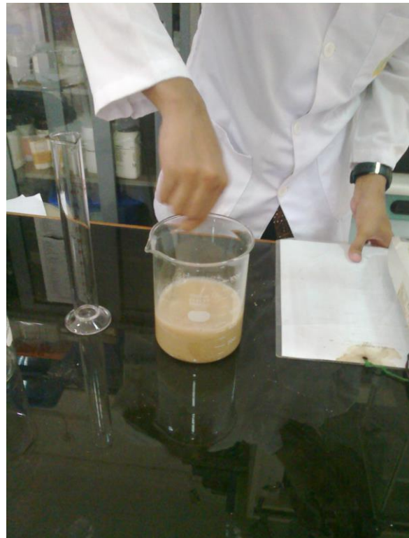
(g) Proses pencampuran antara metanol dan simplisiakemudian diaduk
