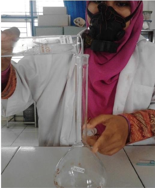
Gambar 16 : pembuatan larutan HCl metoksid
