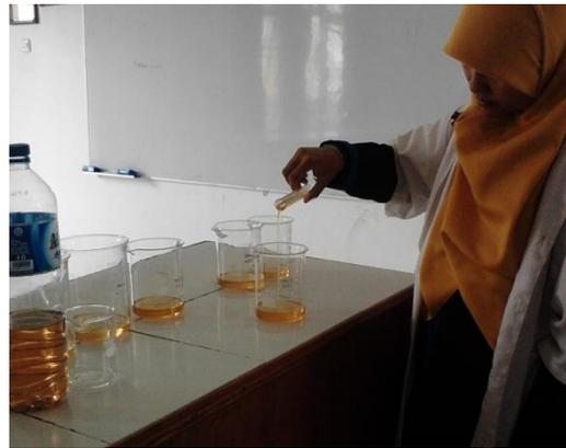
Gambar 31: pencampuran biodiesel dengan solar (B20)
