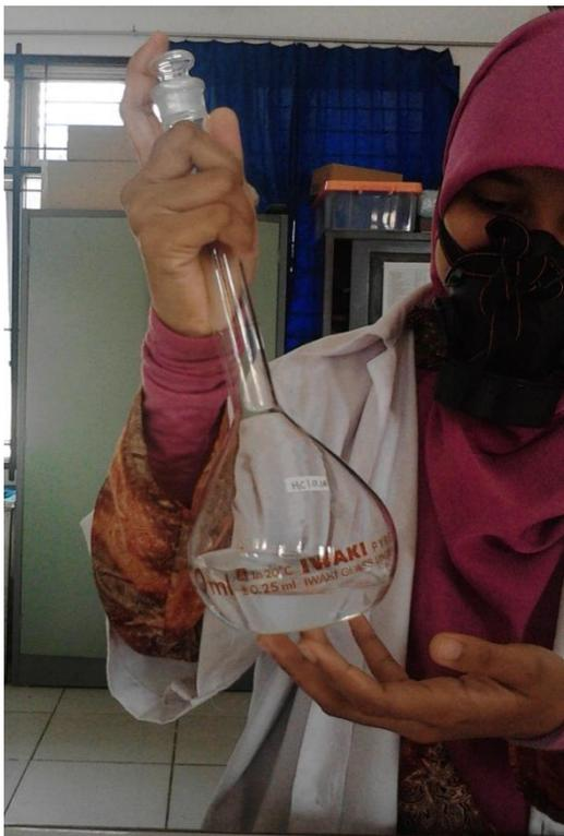
Gambar 17: menghomogenkan larutan
