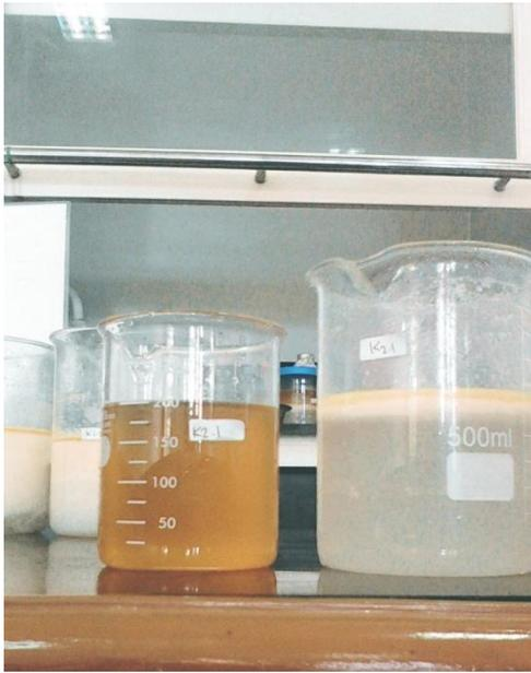
Gambar 7: hasil pengambilan transesterifikasi biodiesel jelantah setelah pencucian
