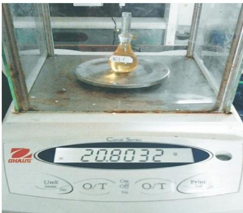
Gambar 29 : penimbangan piknometer basah
