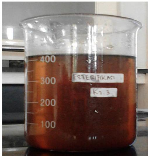
Gambar 1 : Hasil reaksi esterifikasi biodiesel jelantah
