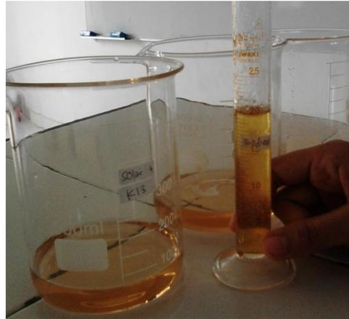
Gambar 30: biodiesel 20 ml dengan solar 80 ml
