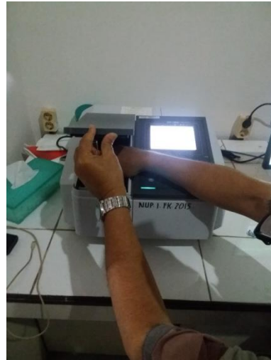
p. ependorf dimasukkan kedalam spektrofotometer
