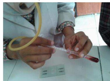
8. Masukkan ujung pipet ke dalam larutan Turk dengan sudut  $45^\circ$ , tahan agar tetap di tanda 0,5. Isap larutan Turk hingga mencapai tanda 11. Jangan sampai ada gelembung udara.
