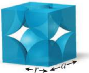
Gambar 4. Hubungan antara panjang rusuk dan jari-jari atom logam dalam kubus sederhana
