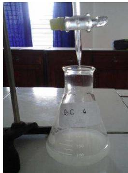
Gambar.13 Larutan dititrasi dengan Natrium Thiosulfat 0,01 N
