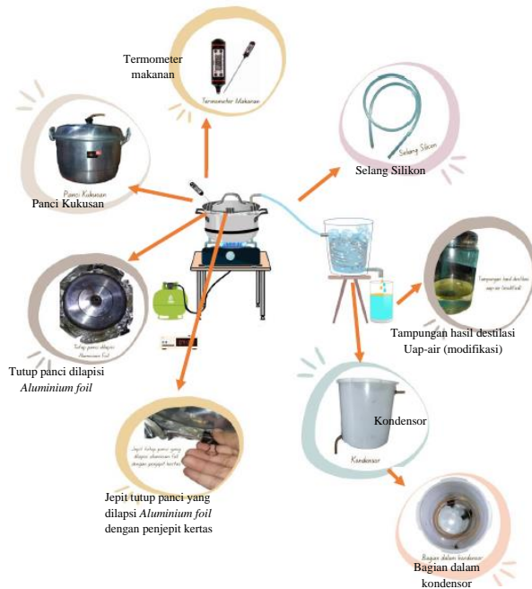
Gambar 2.7 Bagian-bagian Alat Penyulingan Minyak Atsiri Sistem Kukus Termodifikasi
