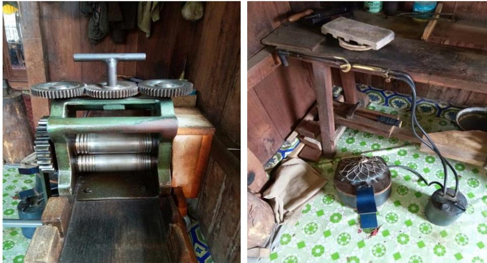
**Gambar 3.3 Mesin gilis atau *rolling mill* dan mesin api**
