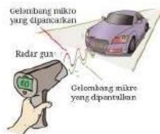
Gambar 2.10 Cara kerja radar gun sumber: Alvin Thambunan Komendiknasdik (2022)
