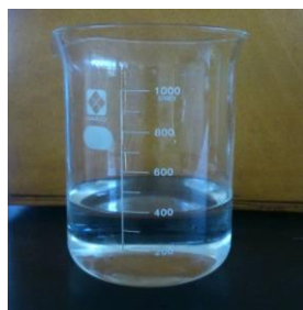
q. Simplisa yang telah disaring ditambah pelarut etanol 96% sebanyak 400 ml
