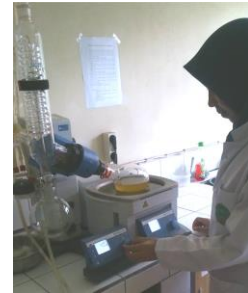
v. Pemisahan ekstrak dari pelarut dengan rotary vacuum evaporator
