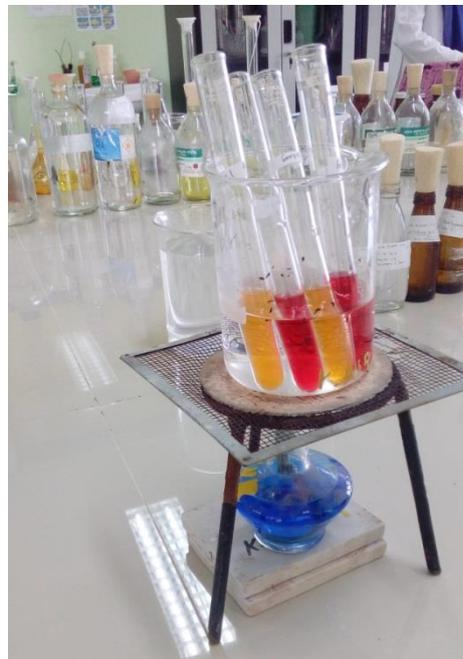
Gambar 14. Pemansan Sampel bertujuan untuk Pemekatan Sampel (Sumber: Laboratorium Kimia Terapan Jurusan Analis Kesehatan Kemenkes Palembang. 2018)
