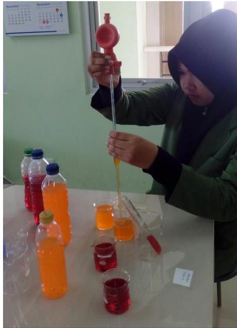
Gambar 13. Sampel dimasukkan ke dalam tabung reaksi sebanyak 10 ml menggunakan pipet gondok (Sumber: Laboratorium Kimia Terapan Jurusan Analis Kesehatan Kemenkes Palembang. 2018)
