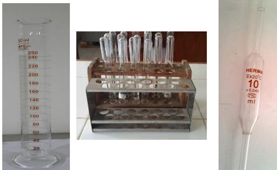
Gambar 4. Gelas Ukur 250 ml, Tabung Reaksi dan Pipet Gondok 10 ml (Sumber:
