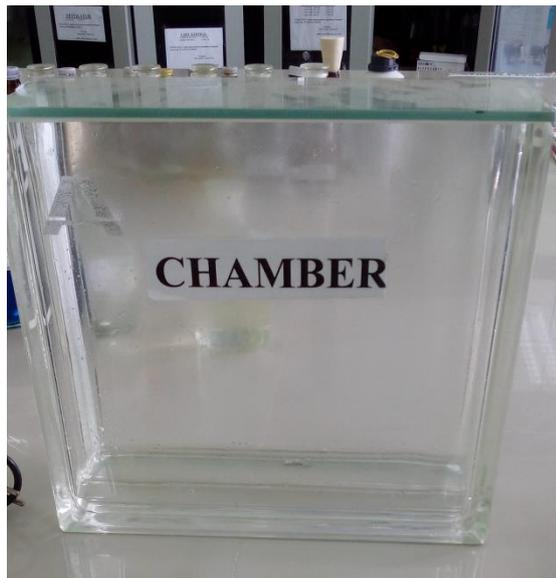
Gambar 17. Larutan NaCl 2 gr dalam alkohol 50% dimasukkan dalam chamber
