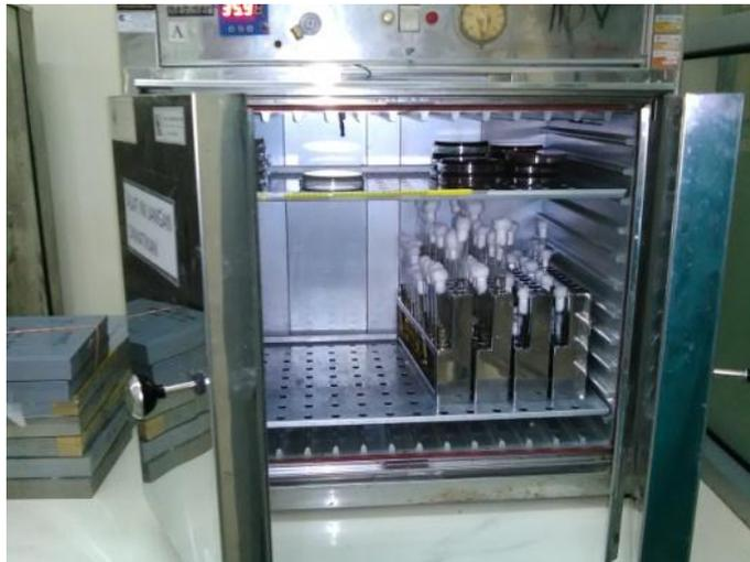
Gambar 8. Proses Inkubasi Sampel Selama 48 Jam Dalam Suhu 37°C
