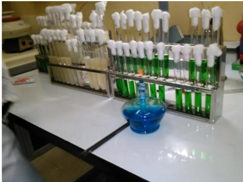
Gambar 10. Media BGLB Untuk Uji Lanjut Dari Tes Pendahuluan ke Tes Penegasan (*Confirmatif Test*) (Sumber: Doc. Pribadi, 2015)
