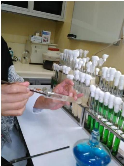
Gambar 12. Pengambilan Sampel Menggunakan Jarum Ose yang Telah Diseterilkan dan Akan Dipindahkan Pada Tabung Reaksi dengan Media BGLB
