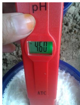
a. Pengukuran pH Lateks Menggunakan Koagulan Asam Semut
