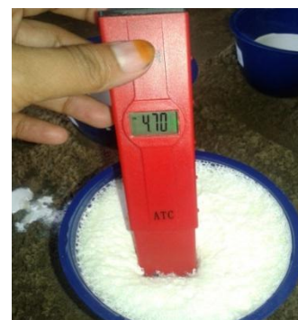
b. Pengukuran pH Lateks Menggunakan Koagulan Limbah Air Rendaman Kedelai
