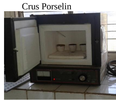
f. Proses Pengovenan Menggunakan Muffle Furnace (suhu 550°C)
