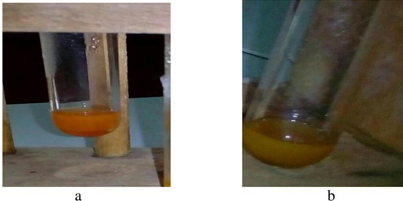
**Gambar 4. Uji kualitatif vitamin C. a) sampel mengandung vitamin C (positif); b) sampel tidak mengandung vitamin C (negatif)**
